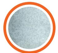
Chapa laminada en caliente o frío revestida en ambas caras con una capa de zinc por el proceso de inmersión en un baño de zinc fundido. Adquiere resistencia a la corrosión. Acabados brillante y matizado.
