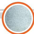
Chapa laminada en caliente o frío revestida en ambas caras con una capa de zinc por el proceso de inmersión en un baño de zinc fundido. Adquiere resistencia a la corrosión. Acabados brillante y matizado.
