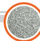
Productos de acero revestidos por el proceso de inmersión en caliente con una aleación de 55% de aluminio y zinc. Se da una elevada resistencia a la corrosión. El revestimiento de Aluminio/Zinc ofrece una combinación de efecto barrera y protección galvánica que mejora su vida útil en aplicaciones de la construcción tanto en ambientes rurales como industriales y marinos.
