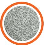
Productos de acero revestidos por el proceso de inmersión en caliente con una aleación de 55% de aluminio y zinc. Se da una elevada resistencia a la corrosión. El revestimiento de Aluminio/Zinc ofrece una combinación de efecto barrera y protección galvánica que mejora su vida útil en aplicaciones de la construcción tanto en ambientes rurales como industriales y marinos.
